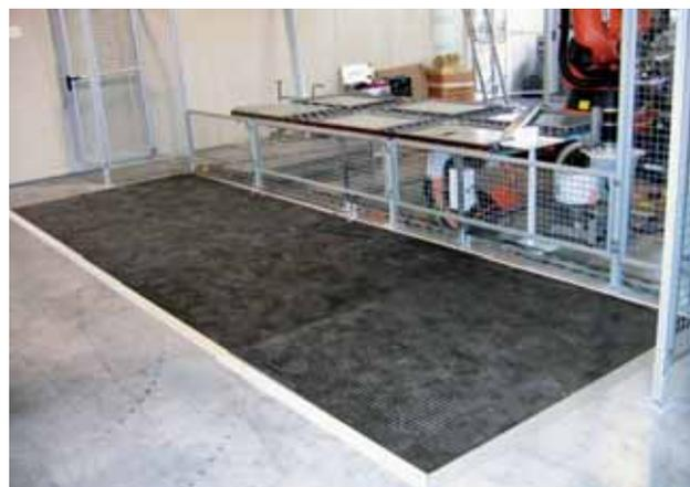
Fig. 5 - Pedana con rivestimento metallico
