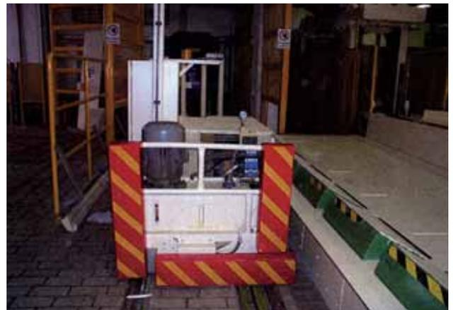
Fig. 12 - Bumper SSZ per protezione carrelli
